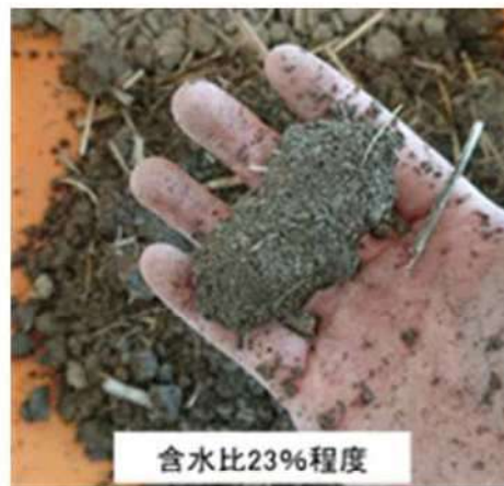
図3-10 含水比と土を握った際の土壤の形状 (灰色低地土)
