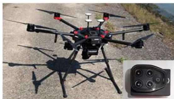
図5-2 ドローンとマルチスペクトルカメラ (右下)
