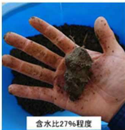
図3-10 含水比と土を握った際の土壤の形状 (灰色低地土)
