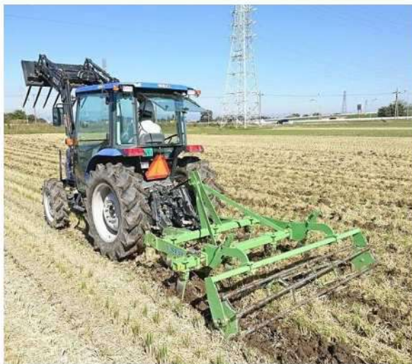
播種前にチゼルプラウで深耕 ※チゼルプラウのあとロータリ耕
